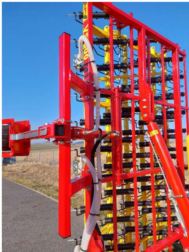
Figure 72 : pose des flexibles le long de la herse 8
