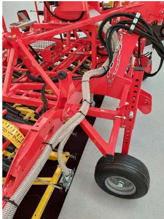
Figure 66 : pose des flexibles le long de la herse 2
