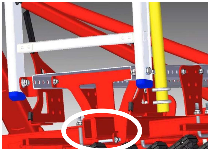
Figure 26 : fixation de la plateforme sur le profilé creux à l'aide d'une vis
