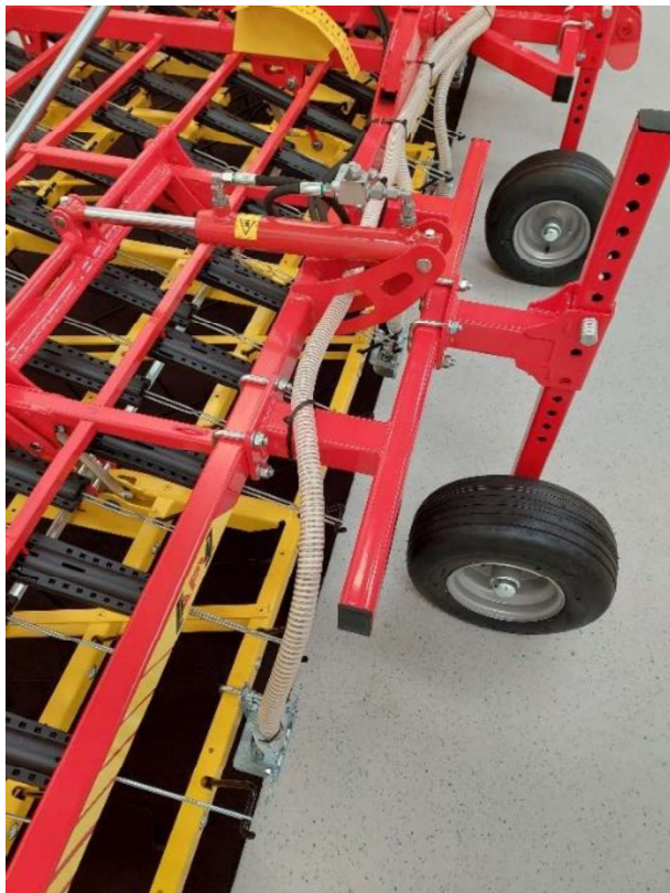
Figure 70 : pose des flexibles le long de la herse 6
