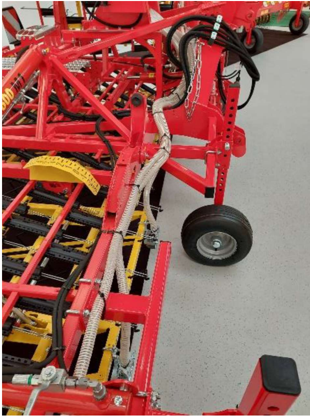
Figure 69 : pose des flexibles le long de la herse 5
