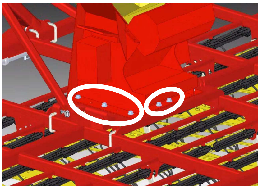
Figure 32 : fixation du PS sur le support à l'aide des vis six pans
