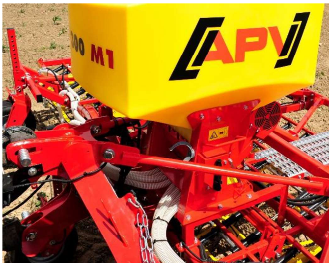
Figure 61 : pose de flexible en partant du PS 1
