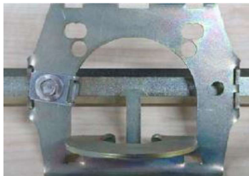
Figure 42 : déflecteur enfilé et fixé sur la barre hexagonale
