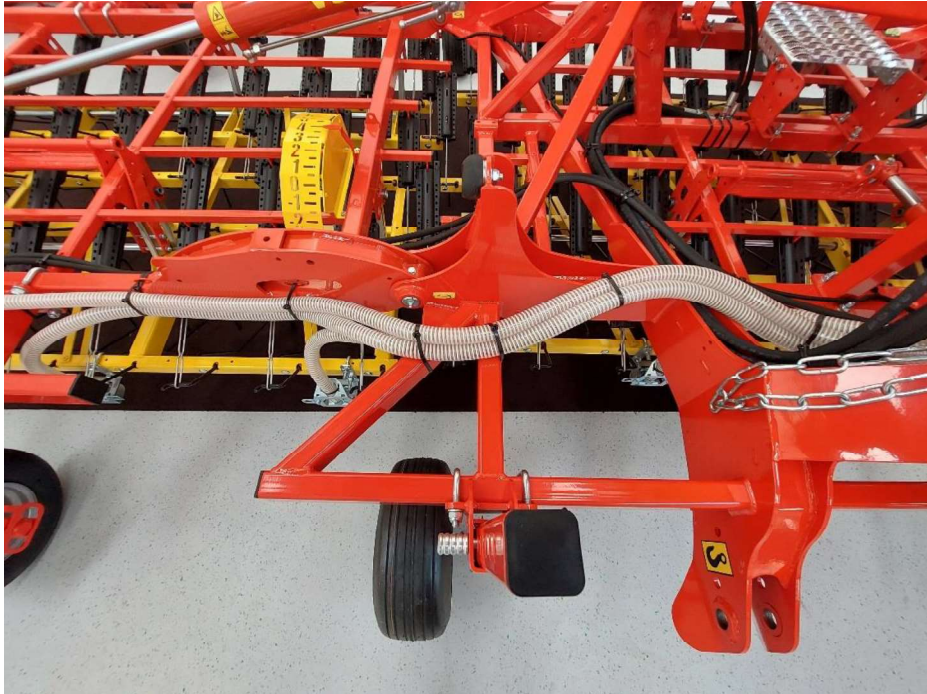
Figure 67 : pose des flexibles le long de la herse 3
